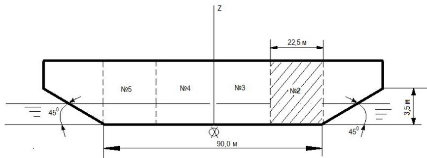
Определить коэффициенты полнот  $\delta$ ,  $\alpha$ ,  $\beta$ . Вычислить и построить гидростатические кривые.
