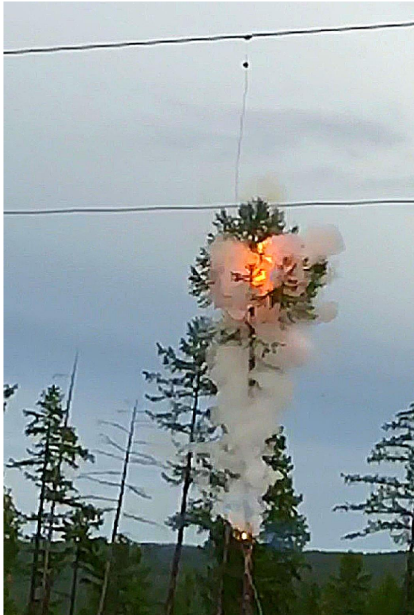
Рисунок 5.49 – Опыт № 2, однофазное КЗ в середине пролета
