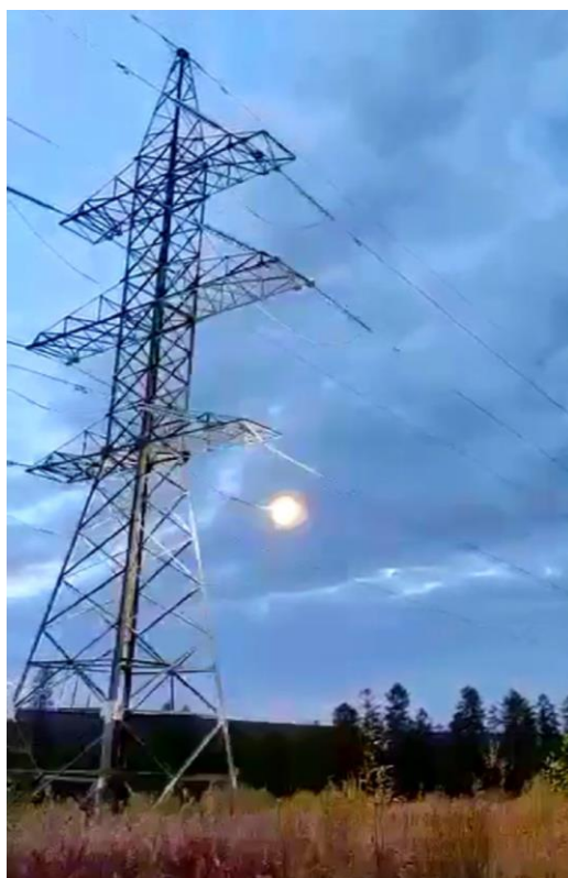
Рисунок 5.48 – Опыт № 1, однофазное КЗ через металлическую опору
