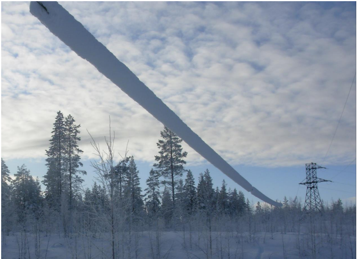
Рисунок 6.30 – Гололедно-изморозевые отложения на фазных проводах наблюдаемой линии
