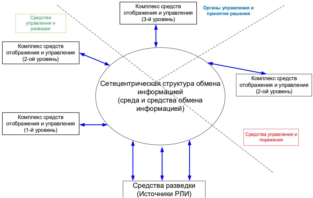
Рисунок 2.17 – Обобщенная структурная схема обмена РЛИ в сетевидной информационной системе
