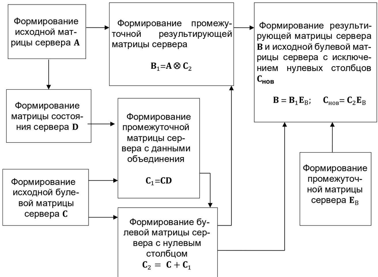
Рисунок 4.7 – Структурная схема алгоритма формирования результирующей матрицы сервера при нарушениях в работе линии связи
