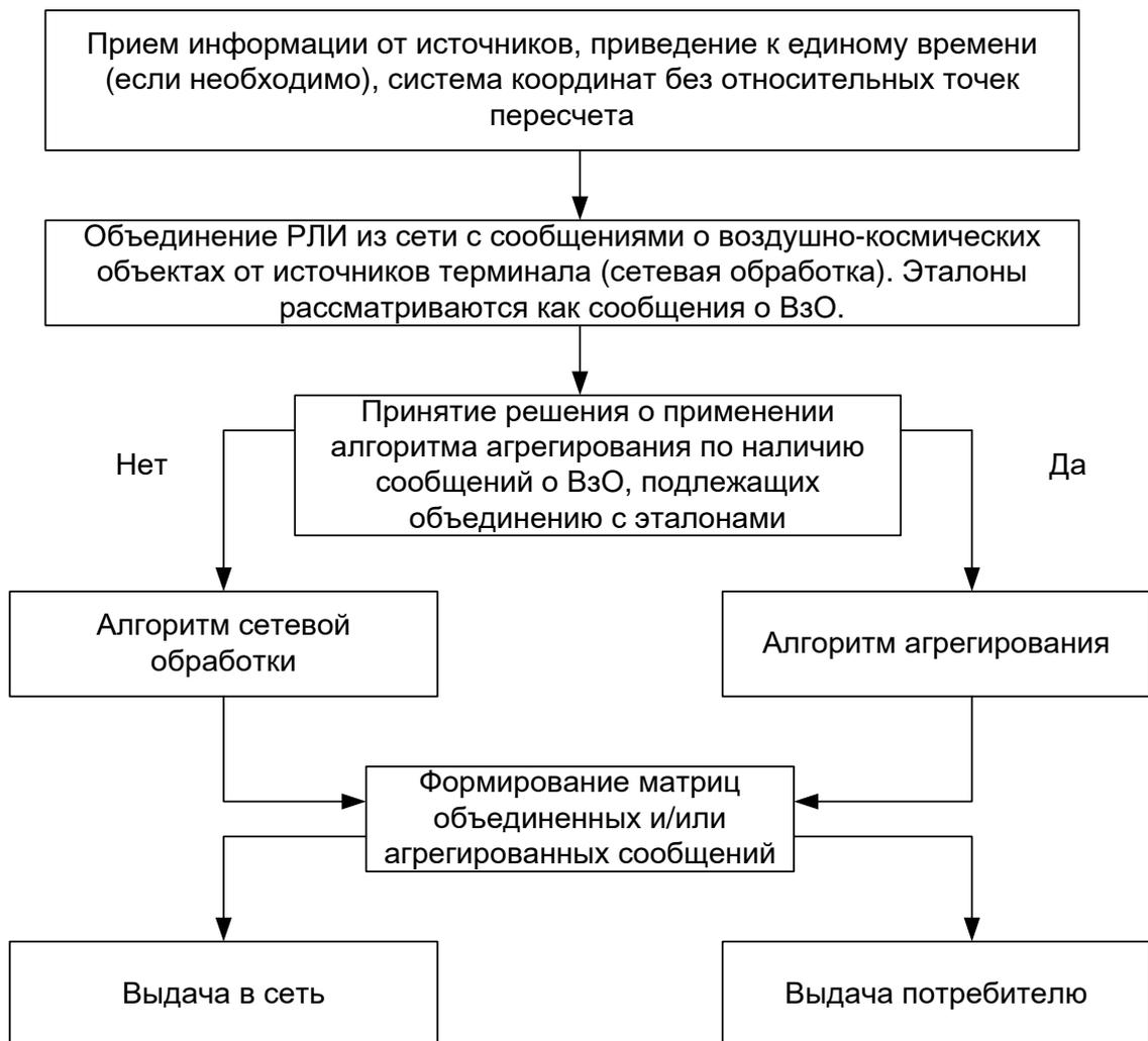
Рисунок 5.5 – Схема взаимодействия алгоритмов сетевой обработки и агрегирования РЛИ в сетевой структуре
