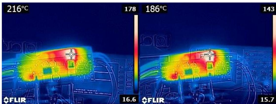
**Рис. 5.9. Тепловые карты электронного блока во время испытаний**
