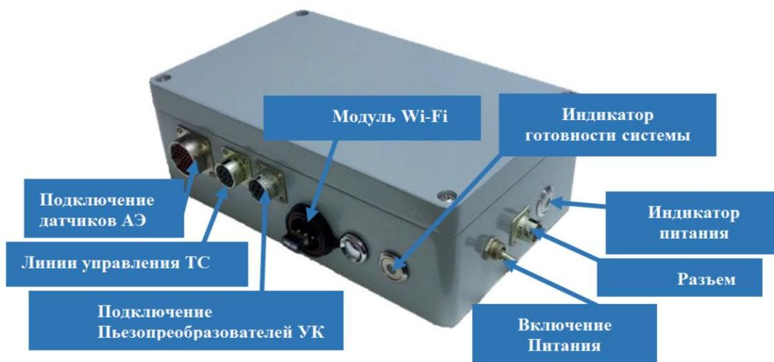
**Рис. 5.44. Внешний вид АПК ИУ**
