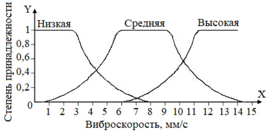
**Рис. 3.11. ФП для значений лингвистической переменной "Виброскорость"**
