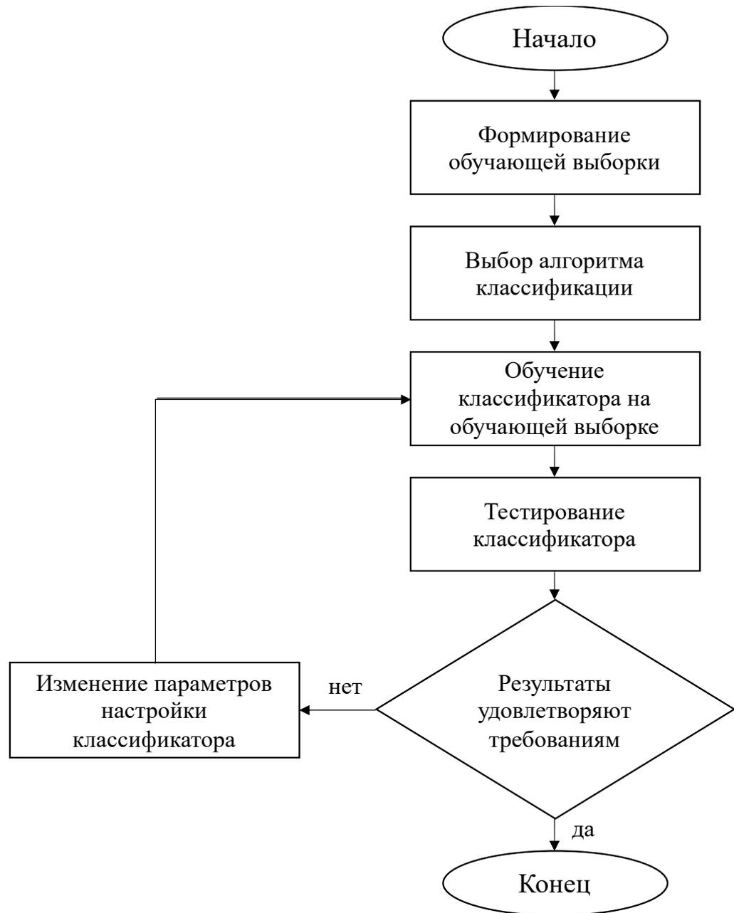
**Рис. 3.18. Обобщенная блок-схема алгоритма ННК**
