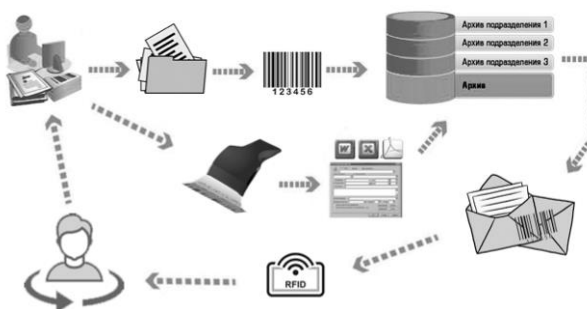
Рис. 3. Структура работы автоматизированного архива в упрощенном виде
