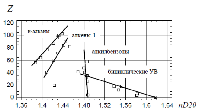
Рис. 1. Зависимость между цетановым числом Z основных групп углеводородов и показателя преломления n_D^{20}
