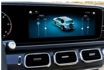
Рис.2. Дисплей мультимедийной системы с изображением регулировки высоты каждой пневматической стойки
