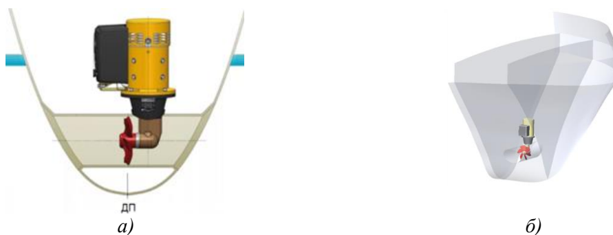
Рис. 1. Моделирование подруливающего устройства в SolidWorks
