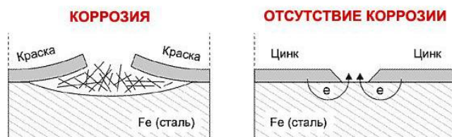
Рис. 1. Коррозия на стали
