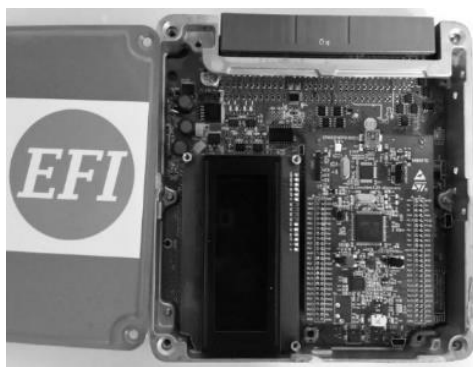
Рис. 1. Электронный блок управления двигателем Frankenso
