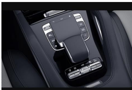
Рис.1. Панель управления дорожным просветом
