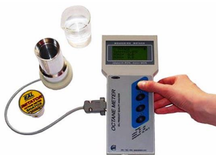
Рис. 1. Октанометр SHATOX SX-100К
