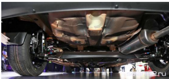
Рис.3. Задняя подвеска Hyundai Solaris 2017
