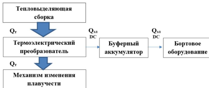
Рис. 1. Схема преобразования тепловой энергии
