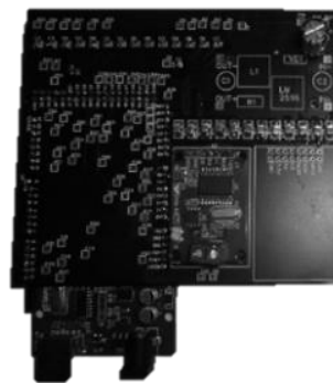
Рис. 2. Электронный блок управления роботизированной трансмиссией
