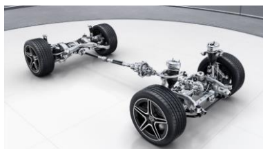
Рис.3. Конструкция гидропневматической подвески Mercedes-Benz – E-Active Body Control
