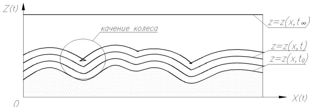
Рис. 5. Рост профиля поверхности z = z(x, t)
