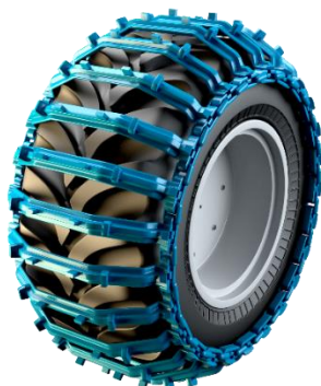
Рис. 5. Траковая цепь с высокими грунтозацепами
