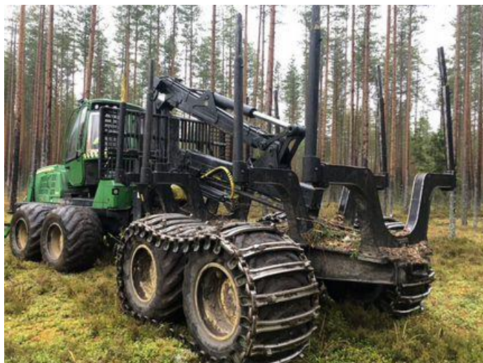
Рис. 6. Транспортное средство, имеющее колесно-гусеничный движитель
