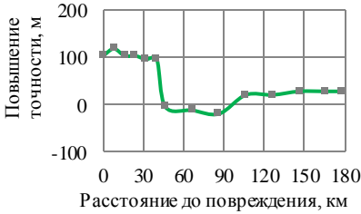
Рисунок 6 – Повышение точности ВОМП в результате применения псевдодальномерного метода
