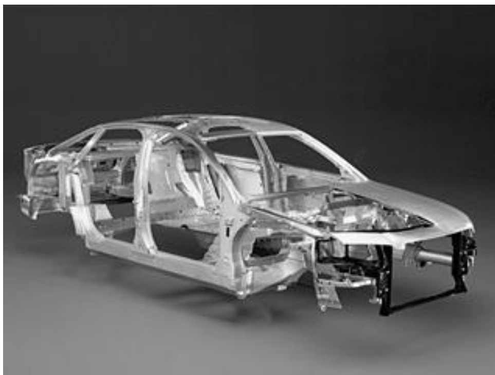
Рис. 5.8. Алюминиевый кузов автомобиля Audi A8
