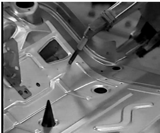
Рис. 4.6. Точечная рельефная сварка на автоматических сварочных машинах
