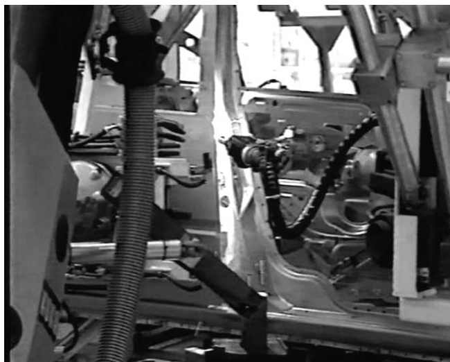
Рис. 4.8. Приваривание дверных петель с предварительной установкой двери в проем боковины при помощи манипулятора
