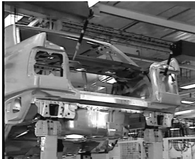
Рис. 4.9. Контроль геометрических размеров кузова на автоматизированных линиях сборки
