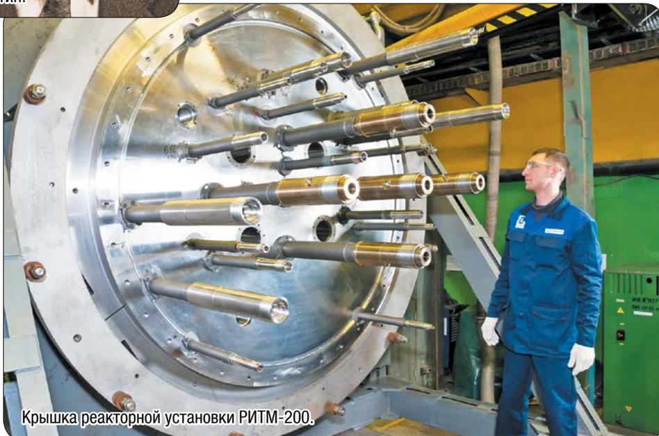
Крышка реакторной установки РИТМ-200.
