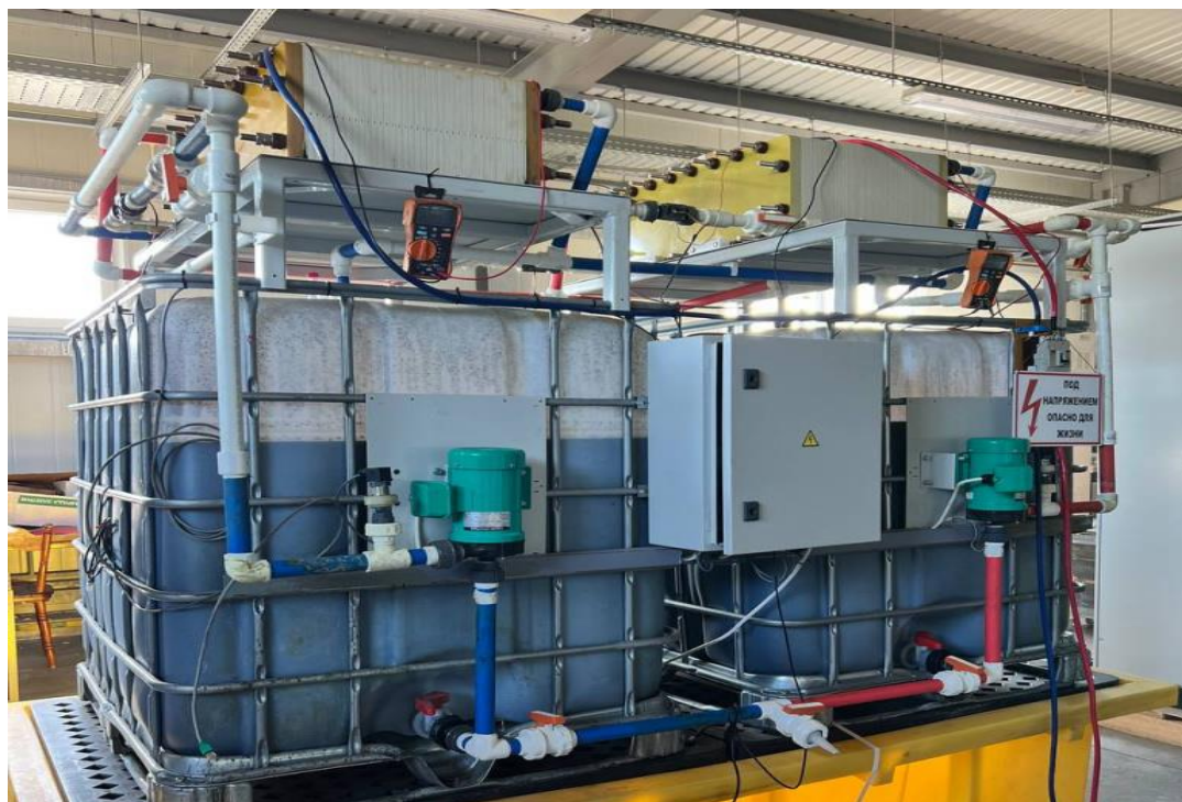
Рисунок 2. Фотография ИБП с двумя стеклами проточных ванадиевых окислительно-восстановительных батарей.
