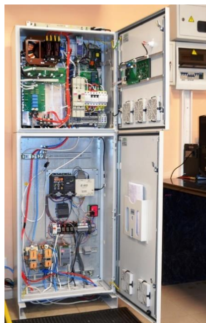
Рисунок 3.9. Проточный накопитель с зарядным устройством и системой управления
