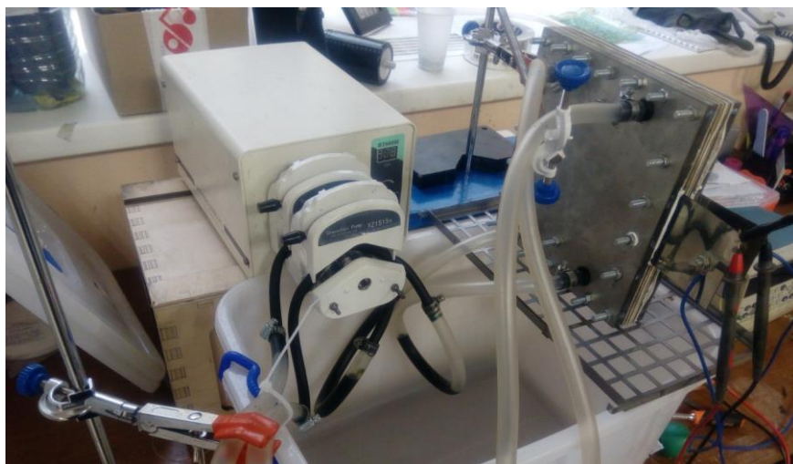
Рисунок 2.10 Ячейка в сборе с гидросистемой
