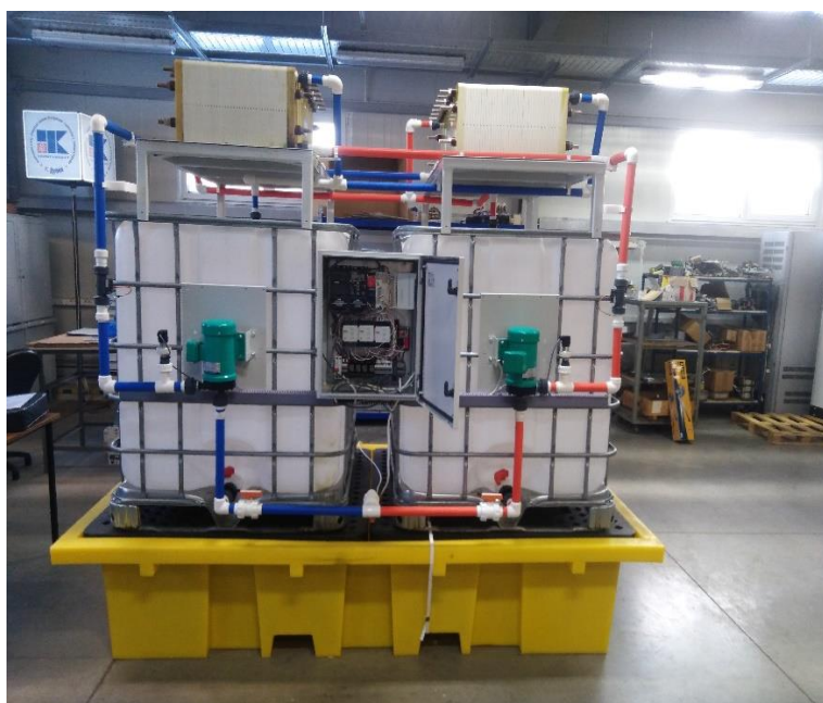
Рисунок 3.9. Проточный накопитель с зарядным устройством и системой управления
