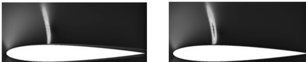
Рисунок 2.3.4 – Трансзвуковое обтекания профиля NACA0012, критерий для плотности (слева) и давления (справа)
