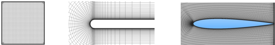
Рисунок 1.4.1 – Геометрии и сетки рассматриваемых случаев
