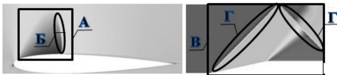
Рисунок 2.3.3 – Поле числа Маха при трансзвуковом обтекания профиля NACA0012 (слева) и поле числа Маха при сверхзвуковом течение в канале с клином (справа)
