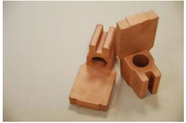
Рисунок 6.5. Фасонные отливки на основе низколегированных сплавов медь – железо (токосъемные элементы)
