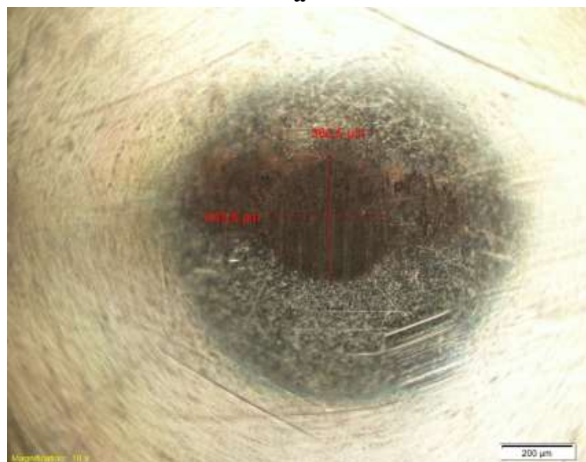
Рис.2 – Образец (x50) сплава без термообработки, контртело (x100), трение со смазкой
