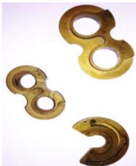
Рис. 6.42. Отливки компенсаторов торцевого уплотнения, изготовленный способом ЛКД
