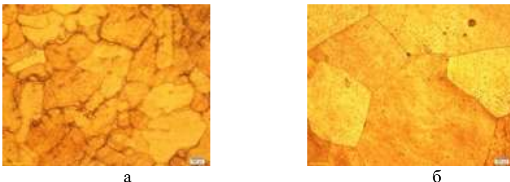
Рисунок 5.34. Микроструктура сплава после второго переплава в литом (а) и термообработанном (б) состоянии (x200).
