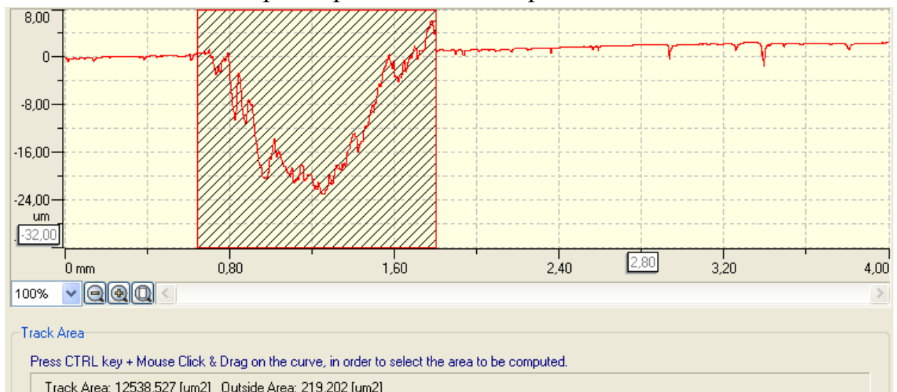
Рис. 5.54. Профилограмма образца сплава медь-железо 2,65% с термообработкой и без применения смазки.
