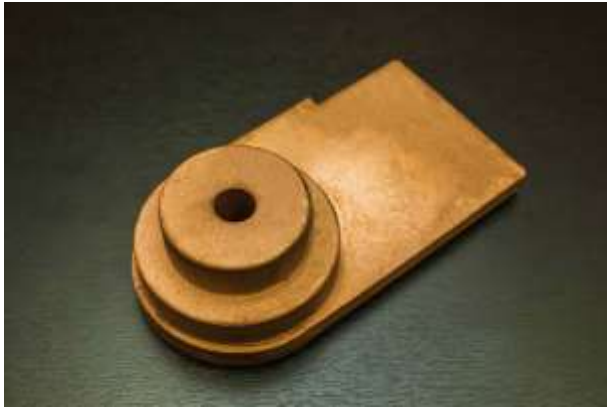
Рисунок 6.3. Фасонные отливки на основе низколегированных сплавов медь – железо (элементы электроники) отливки массой 0,01 – 35 кг, с габаритными размерами 30 – 400 мм, с минимальной толщиной стенки до 3 мм.
