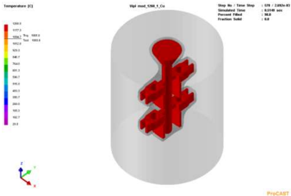
Рисунок 6.24. Поле распределения температуры при заполнении формы на 98 %.
