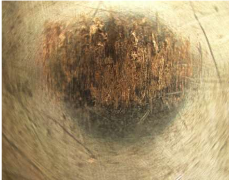
Рис.3 – Образец (x50) сплава после термообработки, контртело (x100), сухое трение
