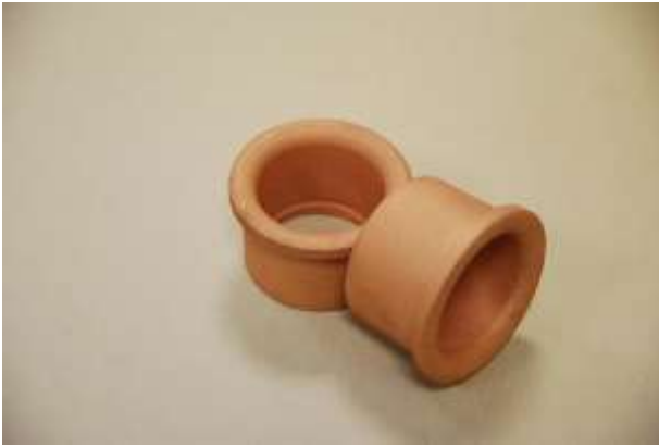
Рисунок 6.5. Фасонные отливки на основе низколегированных сплавов медь – железо (токосъемные элементы)
