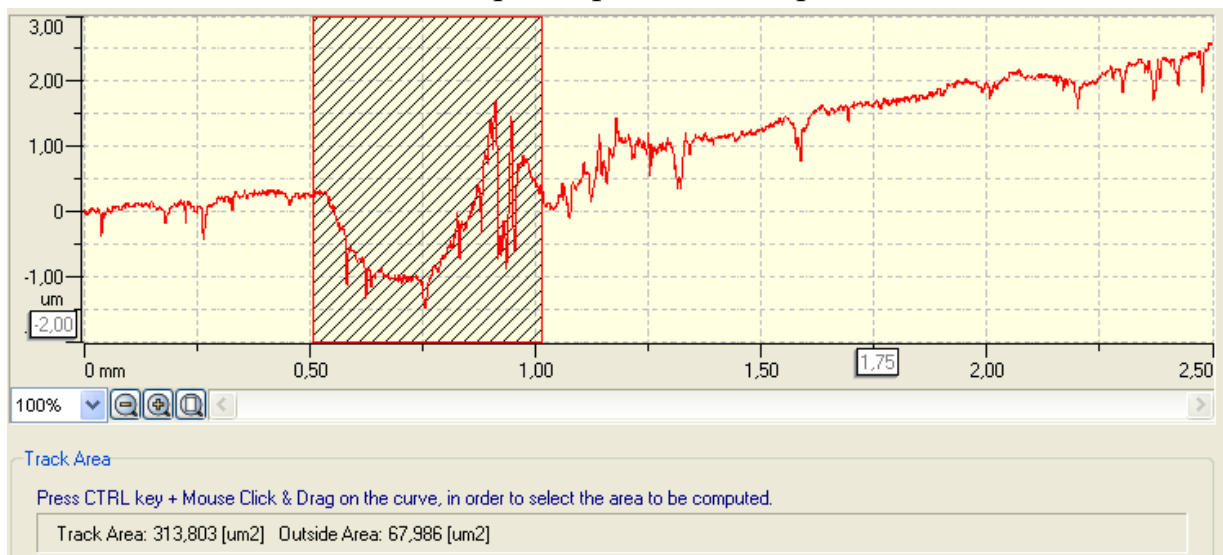
Рис. 5.56. Профилограмма образца сплава медь-железо 2,65% с термообработкой и с применением смазки.
