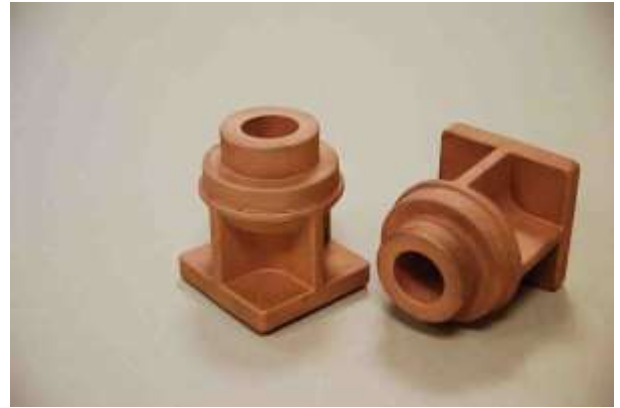
Рисунок 6.3. Фасонные отливки на основе низколегированных сплавов медь – железо (элементы электроники) отливки массой 0,01 – 35 кг, с габаритными размерами 30 – 400 мм, с минимальной толщиной стенки до 3 мм.
