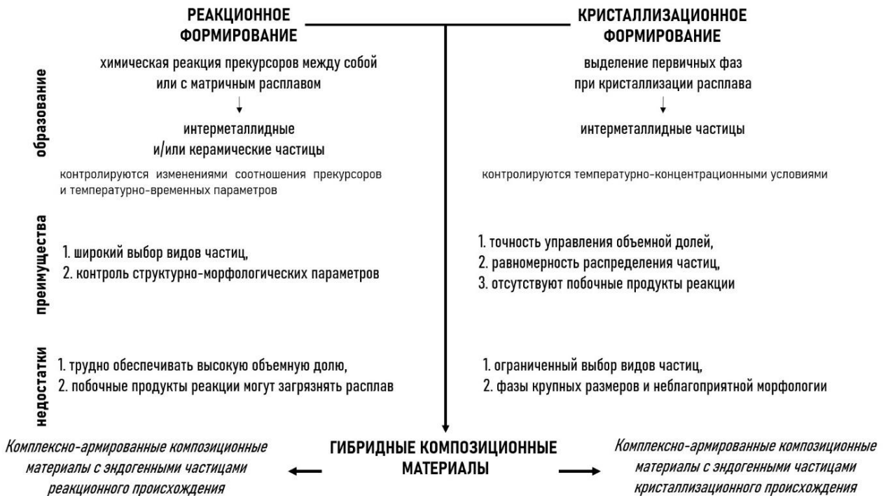
Рисунок 5 – Схема к классификации литых композиционных материалов по происхождению эндогенных армирующих фаз
