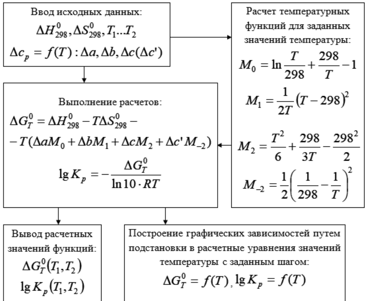
Рисунок 36 – Схема алгоритма термодинамических вычислений
