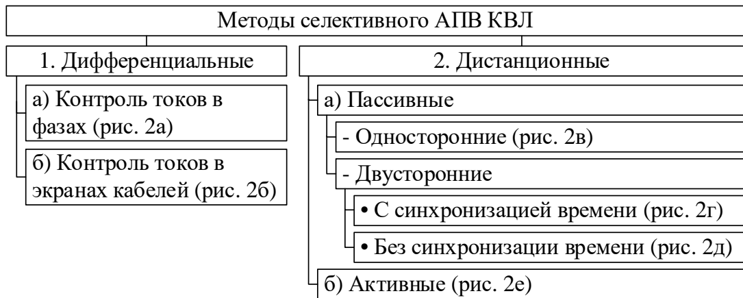
Рисунок 1 – Классификация методов селективного АПВ КВЛ
