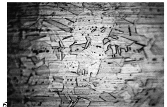
Рисунок 16 – Кривая упрочнения (а) и микроструктура (б) \times 340 стали 12Х17Г9АН4 панелей, изготовленных холодной формовкой на прессе (зоны вершин рифтов)
