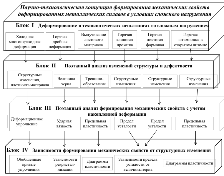
Рисунок 1 – Научно-технологическая концепция поэтапного формирования механических свойств деформированных металлических сплавов в условиях сложного нагружения
