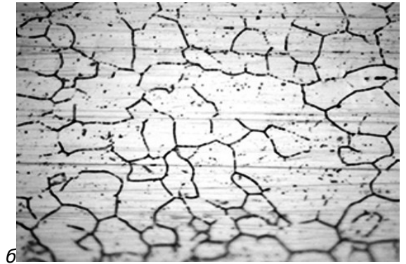
Рисунок 17 – Кривая упрочнения (а) и микроструктура (б) стали 12X17Г9АН4 ( \times 340 ) панелей, изготовленных многооперационной горячей формовкой на молоте (зоны впадин рифтов)
