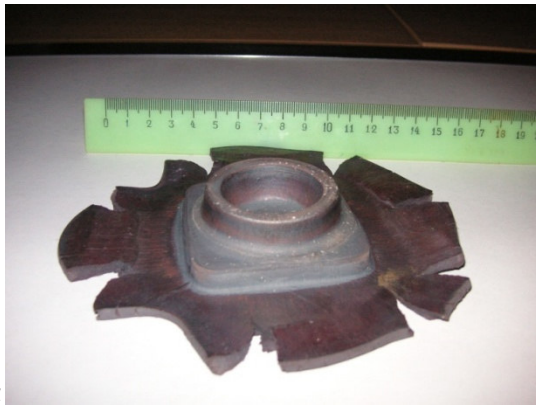
Рисунок 18 – Фотография изделия – фланца (а) и схема резки (б) его четвертой части на слои для микроструктурного анализа
